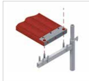
Bild 21: Aufschieben eines Systembelags auf die Einhängezapfen des Vertikalrahmens
