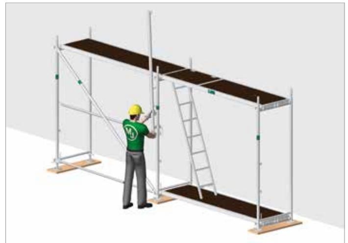
Bild 87: Montage des ersten MSG-Pfostens
