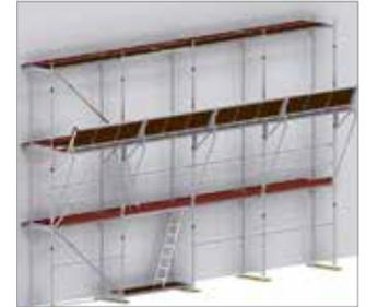
Bild 68: Montage der Belagsicherung für Schutzdachaufsatz
