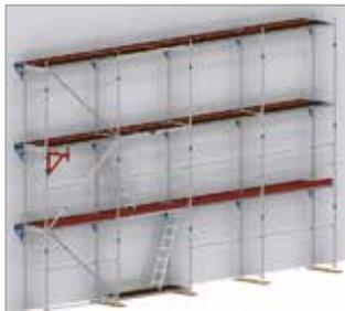
Bild 63: Konsole 0,64 m an der Außenseite des Gerüsts
