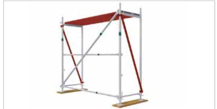
Bild 24: Gerüstfeld mit Querdiagonalen
