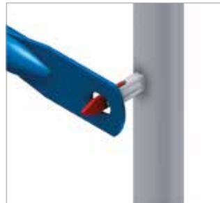
Bild 19: Aufschieben des Geländerholms auf den Kippstift
