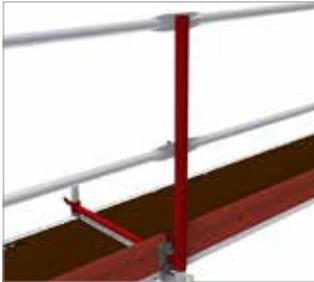
Bild 50: Oberer Abschluss des Gerüsts mit L-förmigem Geländerpfosten, Geländern und Bordbrettern
