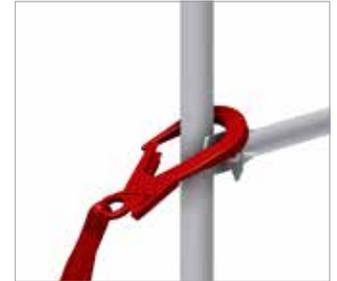
Bild 95: Anschluss am Ständer oberhalb des oberen Geländerholms
