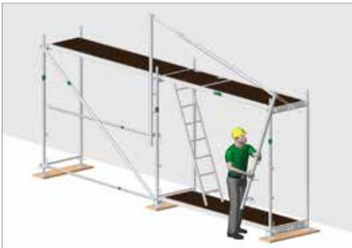
Bild 89: Einhängen des MSG-Geländerholms am zweiten MSG-Pfosten
