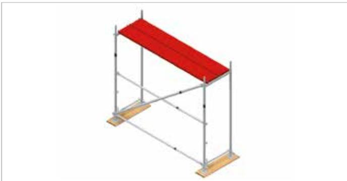
Bild 23: Erstes Gerüstfeld mit eingehängten Systembelägen
