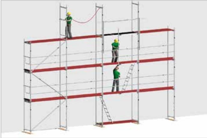
Bild 41: Montage eines Gerüstbereiches mit Hilfe der PSAgA
