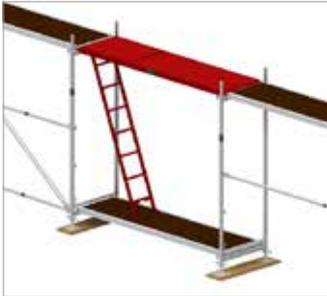
Bild 32: Innenliegender Leitengang, erste Gerüstlage
