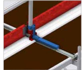
Bild 79: Belagsicherung auf Durchgangsrahmen (Detail)
