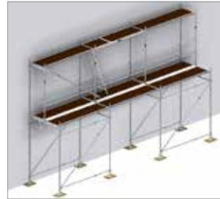
Bild 78: Gerüstabschnitt mit Durchgangsrahmen und Verstrebungen sowie Verankerungen in Höhe  $H = 4\text{ m}$ , Montage der zweiten Lage
