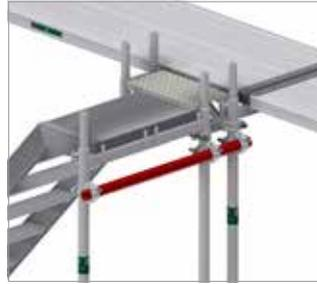
Bild 46: Verbindung zum Hauptgerüst durch Gerüstrohre und Kupplungen
