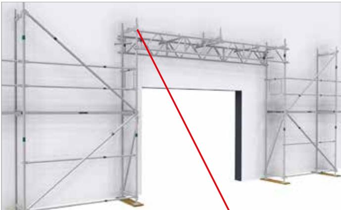
Bild 80: Montage eines Gerüstabschnittes mit Gitterträgerüberbrückung
