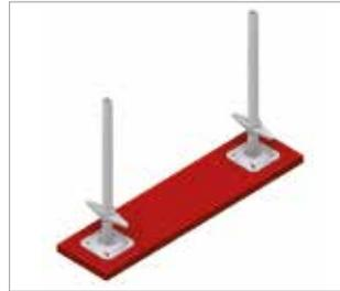
Bild 4: Lastverteilernder Unterbau mit Gerüstbohlen
