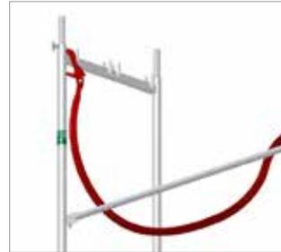
Bild 94: Anschluss am oberen Querriegel des Vertikalrahmens
