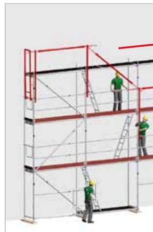
Bild 37: Hochsetzen des Montagesicherungsgeländers (MSG)
